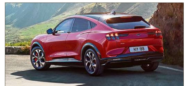
Weil die Batterie in der Bodengruppe steckt, hat das fünftürige SUV viel Platz für Passagiere und Gepäck – vorne gibt es sogar einen zusätzlichen Kofferraum.
